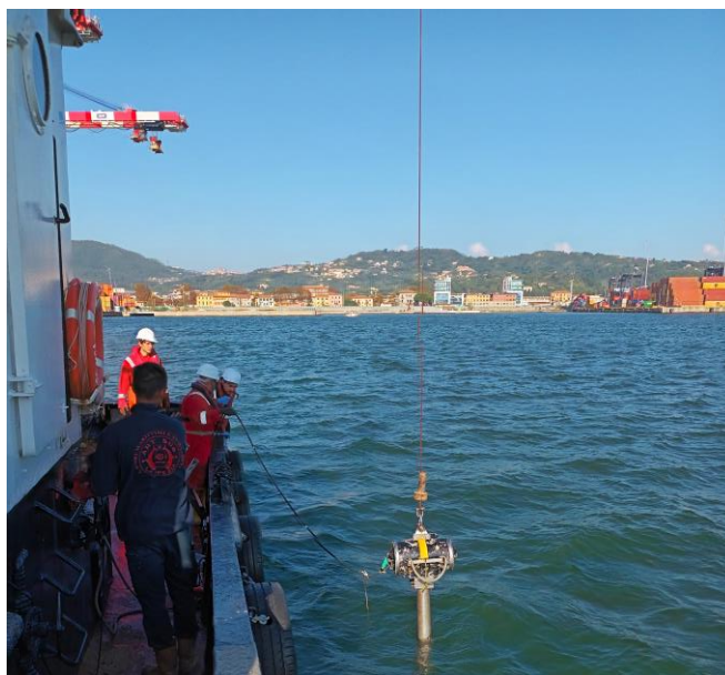
Figura 3 – Condor I attrezzato con vibrocarotiere Rossfelder P3
