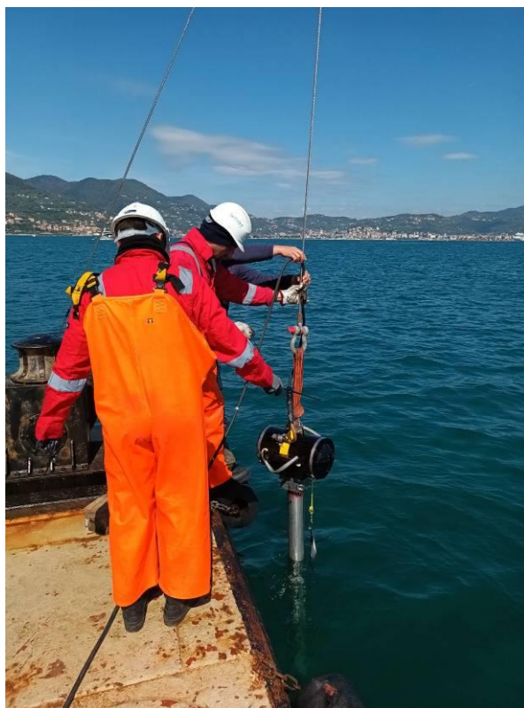
Figura 6 – Operazioni di campionamento mediante vibrocorer
