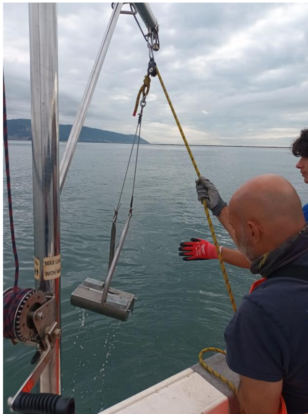
Figura 5 – Operazioni di campionamento mediante benna Van Veen
