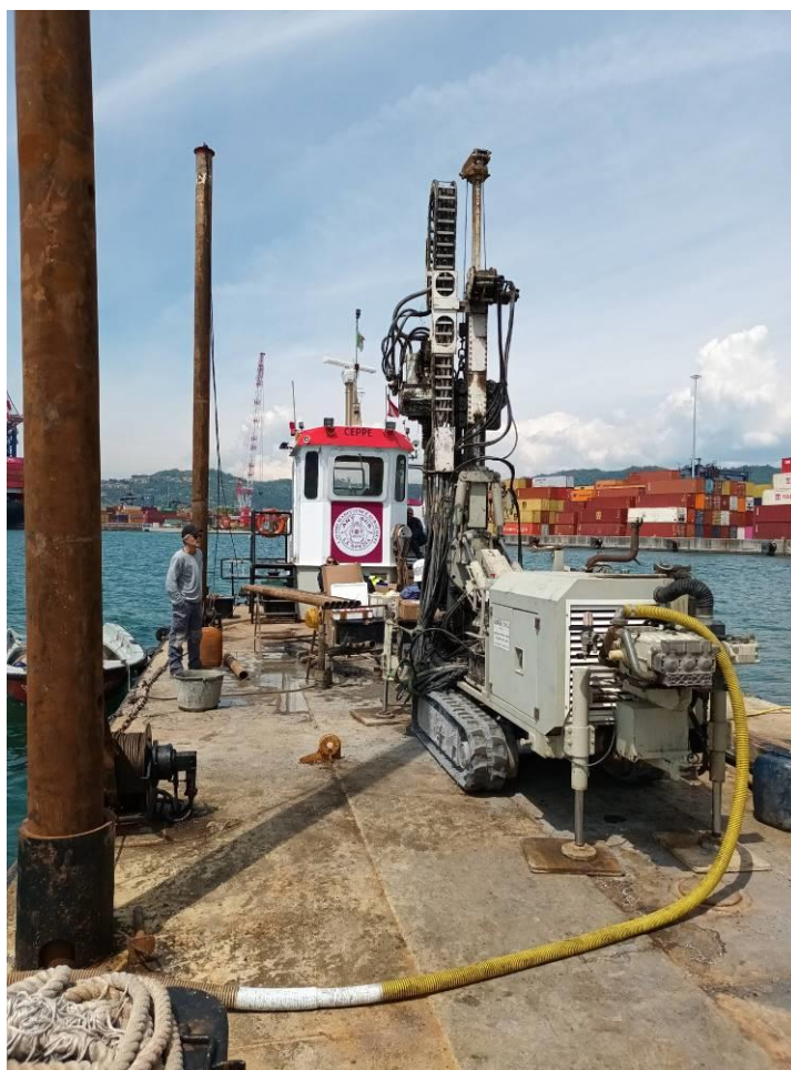
Figura 2 – Pontone "Ceppe" attrezzato con sonda terrestre a rotazione
