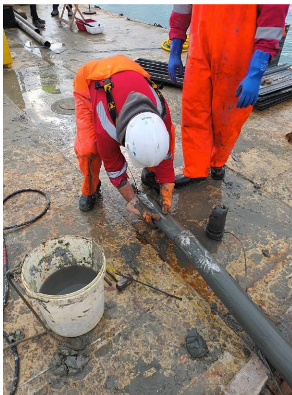
Figura 7 – Esempio di estrusione della carota
